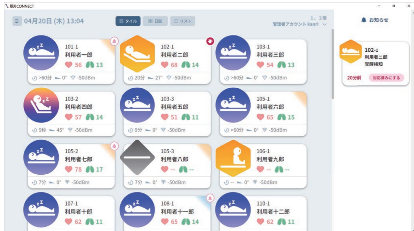
●タイル表示 ベッド上の利用者様の状態を、端末でリアルタイムに一覧表示。あらかじめ設定することで状態(覚醒、起き上がり、離床など)が変化したときや、心拍数・呼吸数*が設定値を一定時間超え続けたときも、端末に通知できます。
